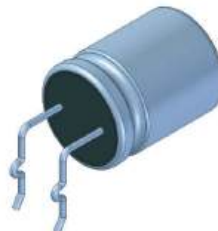
hochgesetzte Montage preparation for raised assembly
